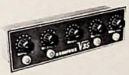
Neuartiger besonders kleiner Mischpultvorverstärker zur Selbsterstellung von Hauptverstärkern. 4 regelbare Eingänge und Tonregelung. Entzerrt und gänzlich brummfrei. Gibt Phase und Gegenphase für die Leistungsröhren (bis 50 Watt) ab. Röhrenbestückung ECC 83, ECC 83, ECC 81. Maße nur 270x80x50 mm. Durch den Nordfunk Vorverstärker ist es nun möglich, erstklassige brummfreie Verstärker selbst herzustellen. Netto DM 88.—
