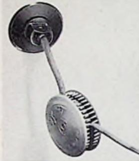
aufgewickelt (Bild), wie man z. B. Garn auf eine Rolle wickelt. Die Zinken verhindern, daß sich die Leitung „selbständig“ macht und von der Spule abrutscht; der Draht läßt sich nur mit sanftem Zug wieder aus dem von den Zinken begrenzten Spulen-Innenraum herausziehen. Preis 2 DM Hersteller: C. & F. Schlotthauer GmbH, Eschwege, Bahnhofstraße 9.
