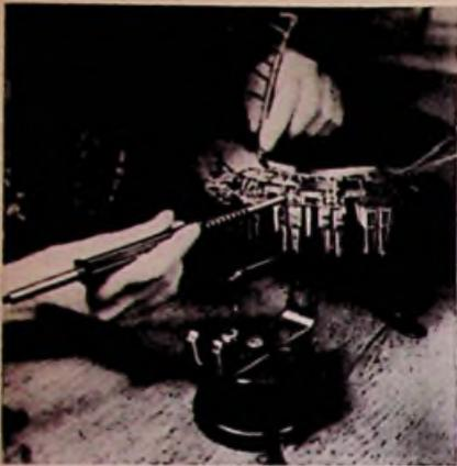
Bild 2. Der auf dem Prinzip der Lötspitze beruhende Mentor-Lötgriffel ist handlich wie ein Kolben
